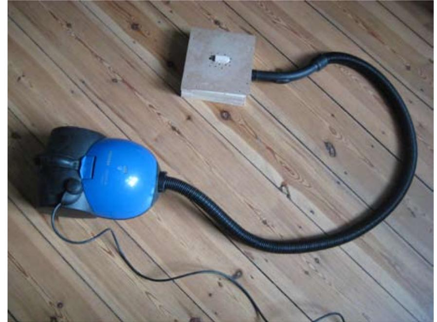
**Bilder oben:** Staubsauger mit Vorrichtung zum Tiefziehen.
